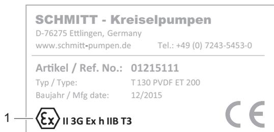
Abb. 2 Typenschild ATEX (Beispiel)
