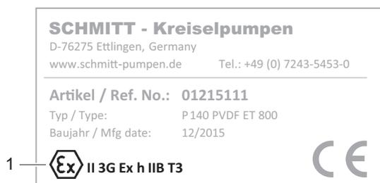
Abb. 2 Typenschild ATEX (Beispiel)
