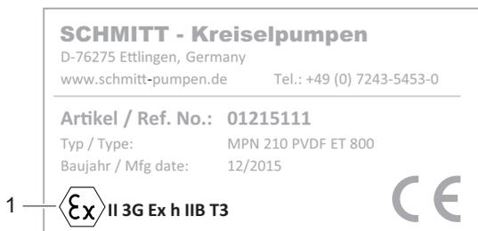
Abb. 2 Typenschild ATEX (Beispiel)
