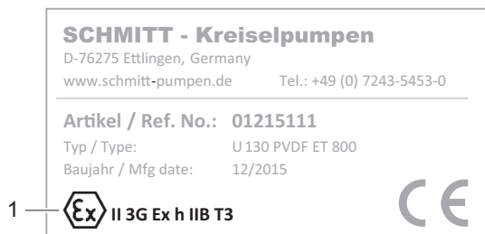
Abb. 2 Typenschild ATEX (Beispiel)
